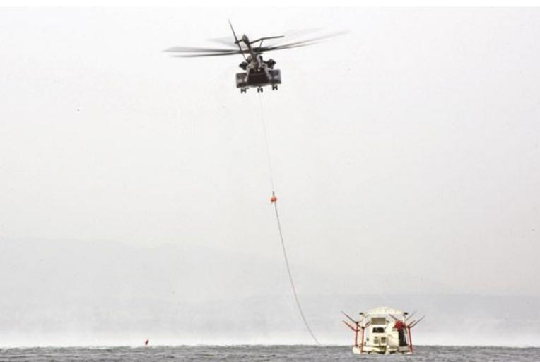
第14直升機掃雷中隊(HM 14)第2A分隊在浦頂附近海域中，以MH-53E掃雷直升機拖曳的Mk105 Mod4磁力掃雷系統進行掃雷演訓，這項裝置可以放出特定電磁場並在安全距離外就引爆水雷，其優異性能讓韓國士官兵嘖嘖稱奇。(Photo by USN)
