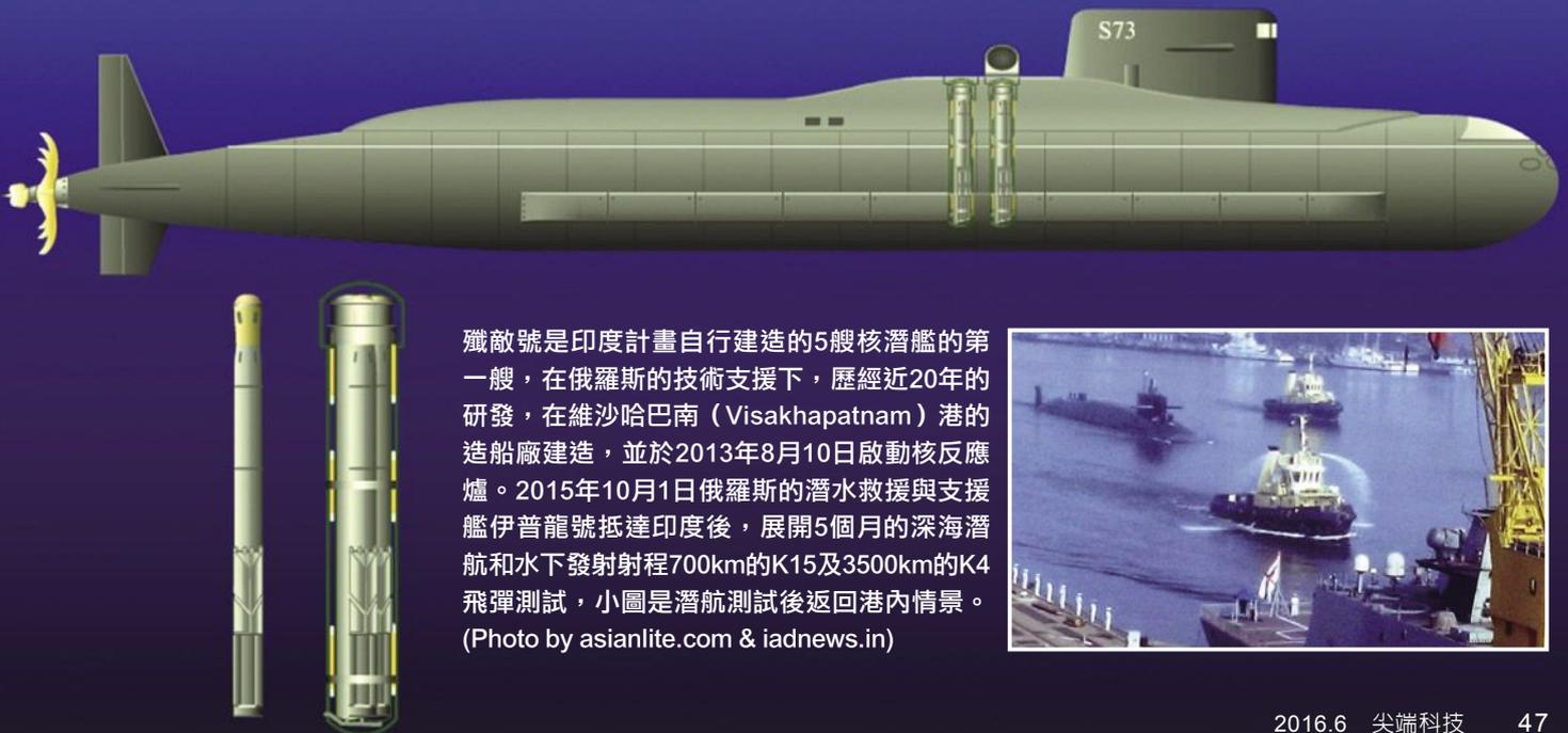
殲敵號是印度計畫自行建造的5艘核潛艦的第一艘，在俄羅斯的技術支援下，歷經近20年的研發，在維沙哈巴南（Visakhapatnam）港的造船廠建造，並於2013年8月10日啟動核反應爐。2015年10月1日俄羅斯的潛水救援與支援艦伊普龍號抵達印度後，展開5個月的深海潛航和水下發射射程700km的K15及3500km的K4飛彈測試，小圖是潛航測試後返回港內情景。
