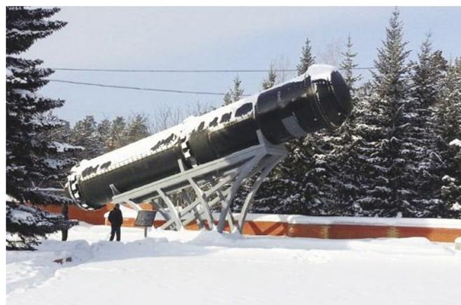
R-39潛射彈道飛彈採用固體燃料火箭，全長為16.1m，直徑2.4m，戰鬥全重84tonnes。(Photo by wikimedia.org)
