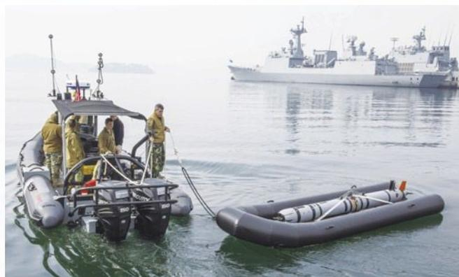
除了直升機外，爆裂物處理機動5隊(EODMU 5)也在3月31日施放了Mk 18 Mod 2無人水下載具，實施獵雷偵蒐的操演。(Photo by USN)
