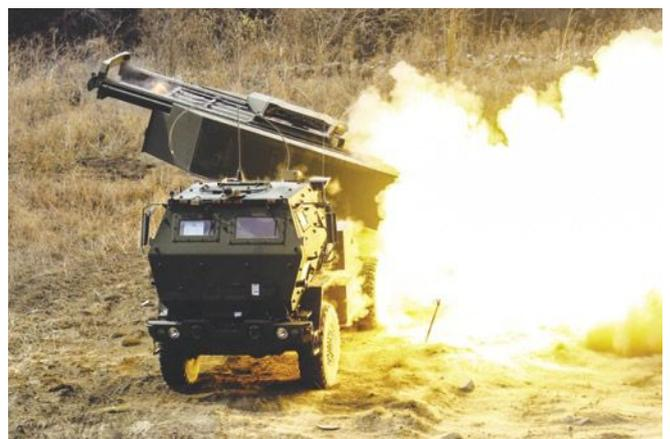
HIMARS是MLRS多管火箭的輕量化空運版，以5噸中型戰術輪車(MTV)做為平台，可攜帶6枚270mm火箭(最長射程32~120km)或者1枚MGM-168 ATACMS飛彈(最長射程300km)，並可與MLRS M270A1的彈藥互換，但是HIMARS只能攜帶M270一半的彈量。(Photo by Wiki)
