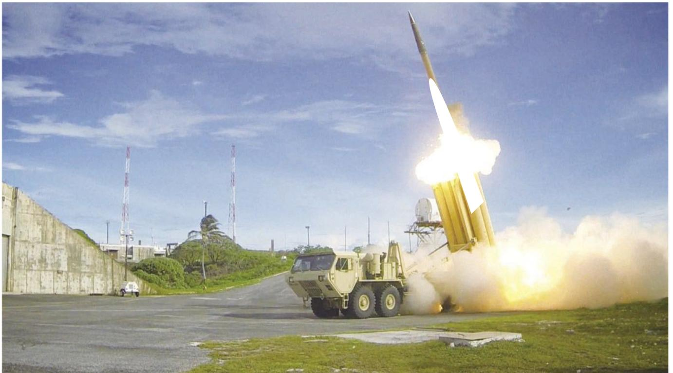
THAAD即是音譯俗稱「薩德」的終端高空防禦飛彈，旨在攔截短、中、遠程彈道飛彈的防禦系統，並能提供射程200公里，最高攔截高度150km的絕佳防護網，為當今性能最優的飛彈防禦系統，也無怪乎中俄會極力反對美方在朝鮮半島部屬此武器。(Photo by US Army)
