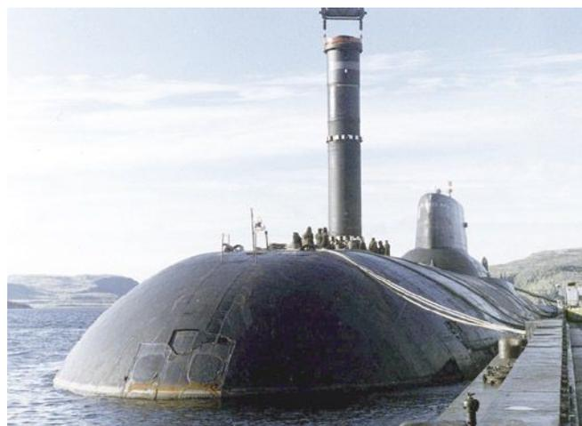
以垂直吊放的方式將R-39潛射彈道飛彈，裝填入颱風級潛艦發射筒內。(Photo by warfare.be)
