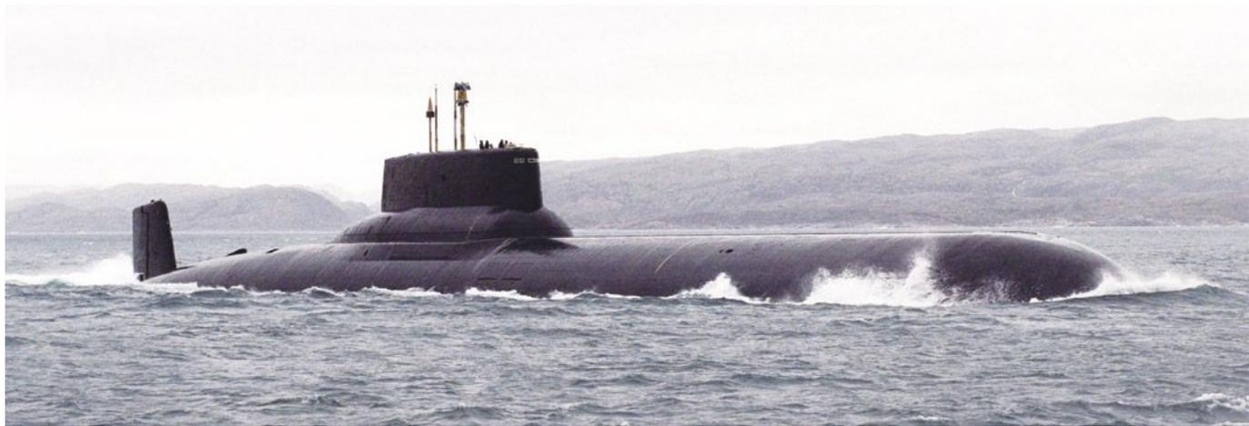
颱風級潛艦長度175m，全寬23m，水面浮航時吃水12.5m，潛航排水量可達到驚人的4.8萬tonnes，至今仍然保持有史以來建造過的尺寸和重量都最大的潛艦紀錄。(Photo by smartage.pl)
