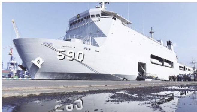
2007年4月29日服役印尼海軍的LPD 590望加錫號船塢登陸艦，擔任本次海上操演的旗艦。望加錫級船塢登陸艦排水量11395ton、全長125m，由韓國釜山造船工程公司所設計，前2艘建於釜山，後2艘在印尼泗水的PT PAL造船廠建造，合約總價1.5億美元。印尼東西兩大艦隊各配屬2艘，擔任旗艦。(Photo by aktual.com)
