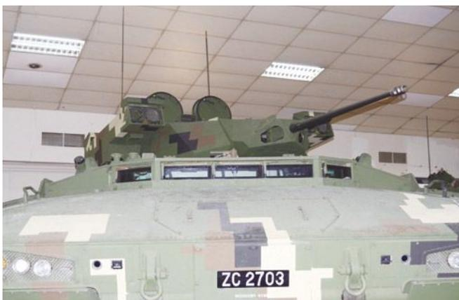
AV8步兵戰車所配備的25mm機砲塔，在其砲塔兩側各裝有二枚反裝甲飛彈發射器。
