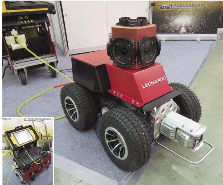
下水道機器人具備觸控式螢幕控制器、200m的線控纜線車、無線操作盒及攝影鏡頭。
